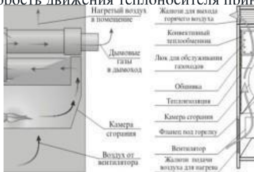
Принципиальная схема работы воздушонагревателя.
